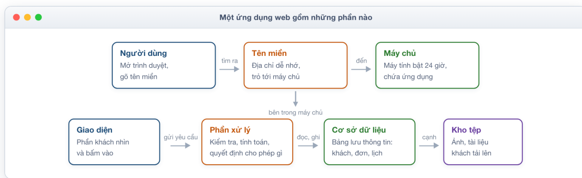
Hình 1. Hàng trên: người dùng gõ tên miền, tên miền chỉ tới máy chủ. Hàng dưới: bên trong máy chủ, giao diện gửi yêu cầu cho phần xử lý, phần xử lý đọc và ghi cơ sở dữ liệu và kho tệp.
